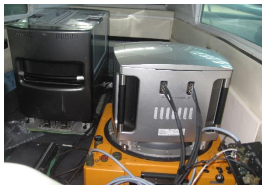
Figura 8: Câmera, plataforma e unidade de armazenamento
